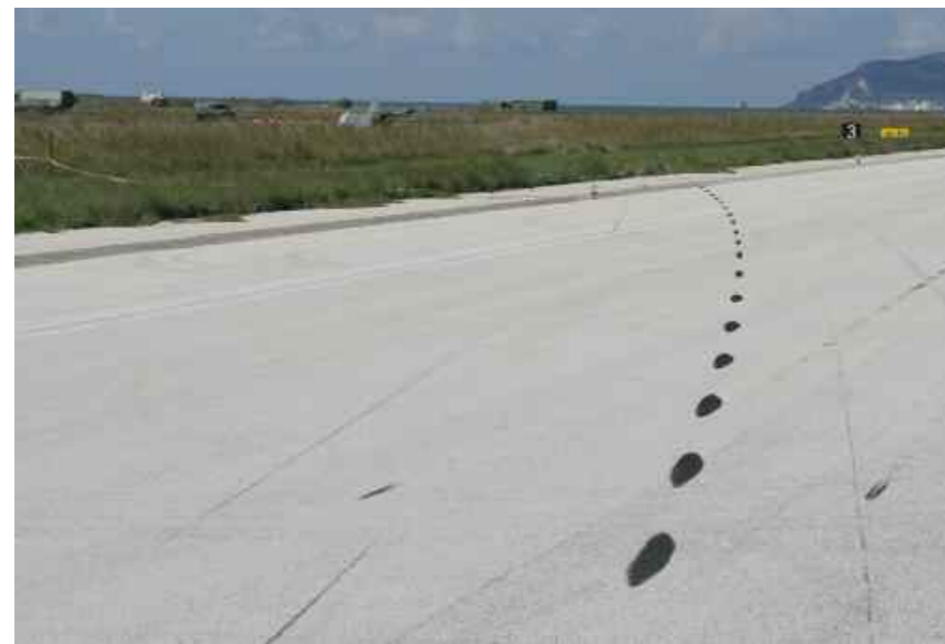
Tracce in pista che evidenziano un comportamento anomalo della gamba carrello sinistra
