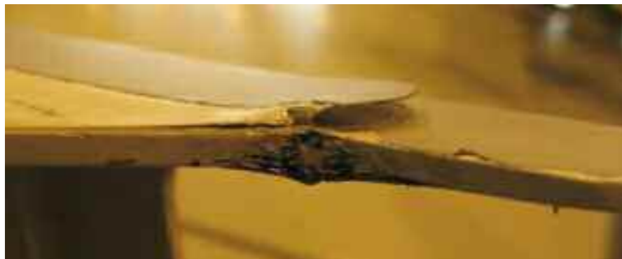
Fig. 12 - EF 2000 fairing 342 AT. crashing e delaminazione dei bordi posteriori del pannello in CFC a seguito di clearance insufficiente con la base della deriva
