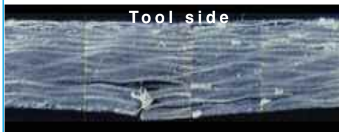
Fig. 7 - Delaminazione su laminato in CFC
