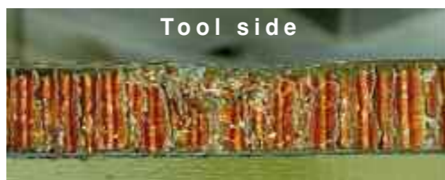
Fig. 8 - Danneggiamento honeycomb in Nomex
