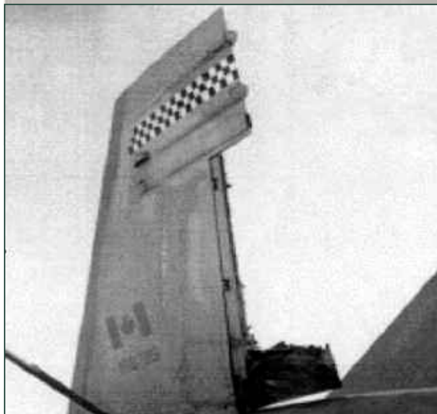
Figura 18 – Perdita in volo del timone di un CF18 canadese (441 Sqn, 1999)
