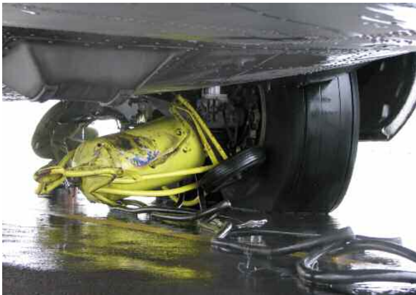
Particolare della gamba carrello destra con l'estintore incastrato
